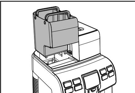
**4** Den Tank ausspülen und mit frischem Wasser füllen. Der Füllstand (MAX), der im Tank markiert ist, sollte nicht überschritten werden.
