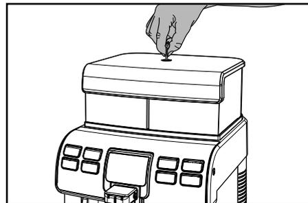
**2** Nach der Entriegelung wird die Abdeckung durch Anheben entfernt.
