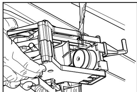
**6** Den inneren Behälter im hinteren Bereich anheben, um ihn zu lösen.
