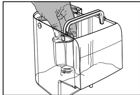
**13** Den Tank mit frischem Trinkwasser füllen und wieder in die Maschine einsetzen.
