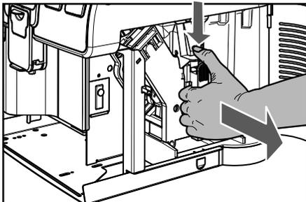
**4** Den inneren Behälter im hinteren Bereich anheben, um ihn zu lösen.
