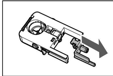
**13** Den Anschluss des Ansaugschlauchs aus dem Cappuccinatore entfernen.
