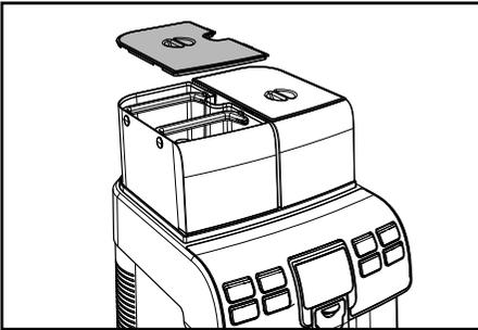
**3** Den Tank entfernen, indem er an den im Inneren angebrachten Handgriffen angehoben wird.
