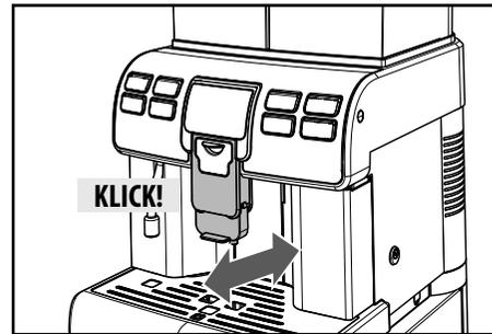
**i** Sicherstellen, dass der Auslauf korrekt positioniert wurde. Er wird horizontal verschoben, bis der KLICK zu hören ist, mit dem die korrekte Positionierung angezeigt wird. Im gegenteiligen Falle ist der Austritt des Produktes aus dem äußeren Bereich des Auslaufs möglich.
