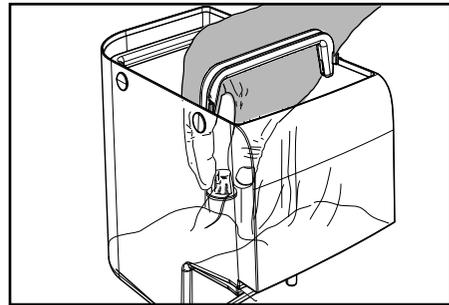
**12** Den Wasserfilter in den leeren Tank einsetzen. Bis zum Einrasten drücken.
