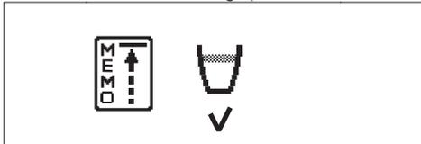
Ab diesem Zeitpunkt muss die Taste „OK“ gedrückt werden, sobald die gewünschte Kaffeemenge in die Tasse ausgegeben wurde. Nun ist die Taste "Espresso" programmiert. Bei jedem Druck gibt die Maschine die soeben programmierte Menge aus.
