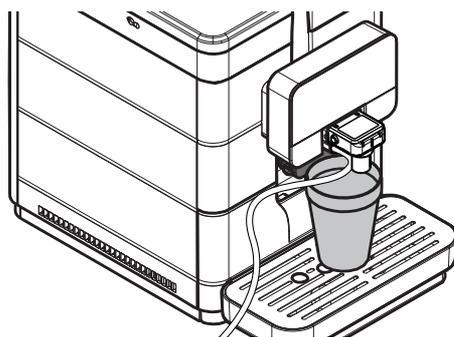
Ist die Maschine bereit, wird die Taste „Milk“ gedrückt, um die Ausgabe der heißen Milch zu starten.
