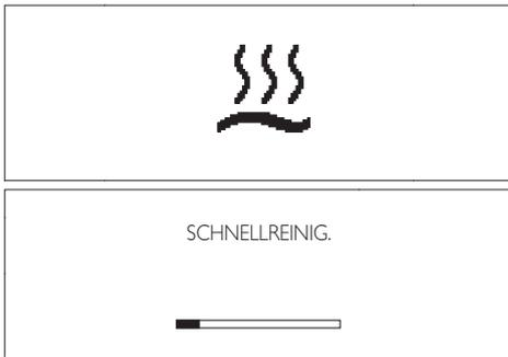
In diesem Fall wird die Reinigung nur mit heißem Wasser durchgeführt und den Ansaugschlauch wird nicht verwendet. Am Ende des Reinigungszyklus, unter laufendem Wasser reinigen. Abwarten, bis der Zyklus automatisch beendet wird. Die Maschine kehrt im Status Betriebsbereit zurück.
