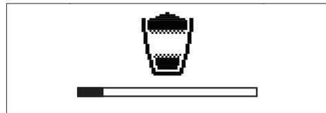
In dieser Phase gibt die Maschine die aufgeschäumte Milch aus. Die Ausg. kann durch Druck der Taste „Cappuccino“ beendet werden.
