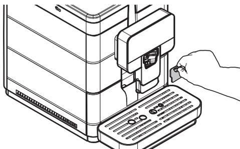
Den Cappuccinatore bis zum Anschlag in seine Aufnahme einstecken. Kontrollieren, dass dieser nicht heraus rutschen kann.
