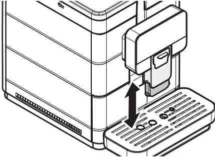
Für diese Einstellung wird der Auslauf von Hand nach oben oder nach unten geschoben.
