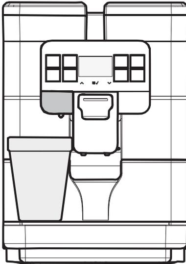
Die Taste für die Ausgabe von „Hot Water“ drücken. Innerhalb weniger Sekunden beginnt Heißwasser aus der Düse zu fließen.
